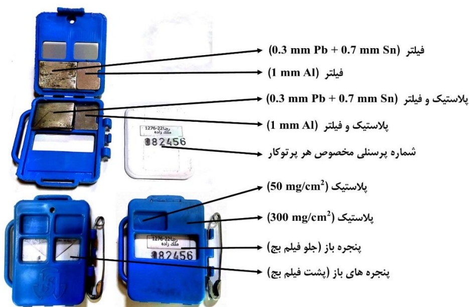
شکل ۲ دوزیمتر فیلم بیج و اجزای آن.
